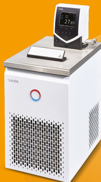
恒温器Lauda ECO RE 415S 用于制冷和制热 样品(-15 ... 200) °C
