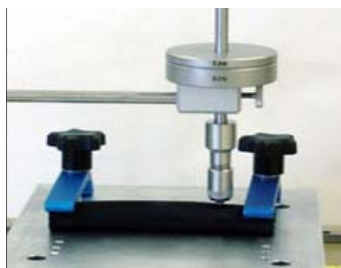
图示: 加厚物件的磨耗测试
