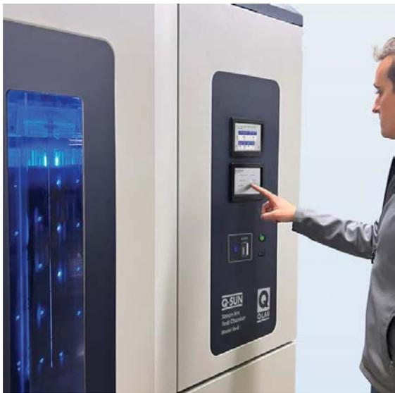
在新时代下，以性能为核心的测试标准正引领着汽车外部材料耐候性测试的革新。Q-SUN Xe-8 氙灯老化机凭借其卓越的光谱输出、精准的温湿度控制以及优化的喷淋系统，不仅完美适应 SAE J2527 标准，更为行业带来更可靠、更高效的测试体验。
